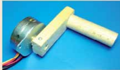
Şekil 13: Çevirme kolu montajı
