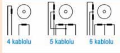
Şekil 12: Kablo bağlantıları
