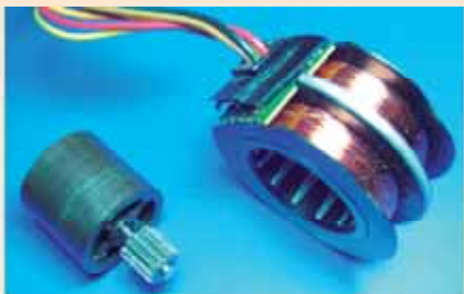
Şekil 11: Adım motorunun iç yapısı
