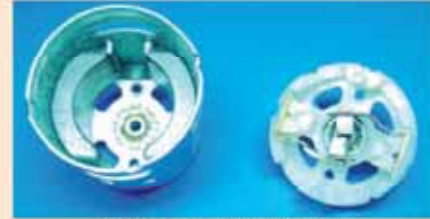
Şekil 6: Stator ve fırça yapısı
